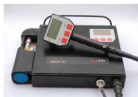
รูปที่ 10 แสดงตัวอย่างเครื่องตรวจวัดระดับสารระเหยอินทรีย์ชนิดเฟรมไอออไนส์เซชัน (Frame Ionization Detector: FID)
