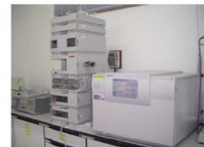
รูปที่ 18 แสดงตัวอย่างเครื่องวิเคราะห์ Liquid Chromatograph-Mass Spectrometer (LC-MS)
